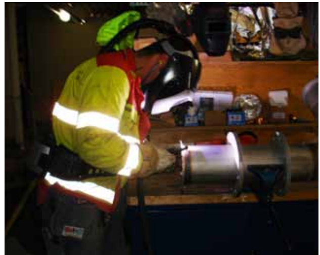
Svetsning på arbetsbänk sker i en framåtlutad position.
